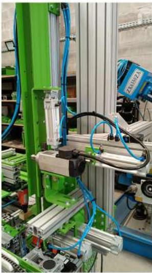
Furação automática para esvaziar os gases de colagem de forma automática (furo diâmetro 8).
