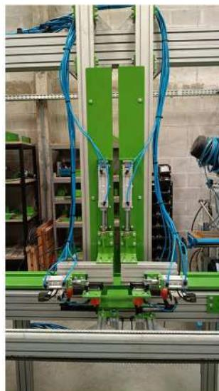
Posicionamento e grampo em automático do reforço da fechadura.
