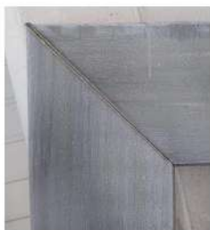
Resultado da solda do produto para portas
