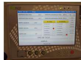
Ciclo de trabalho e controle de temperatura com CLP touch de 7"
